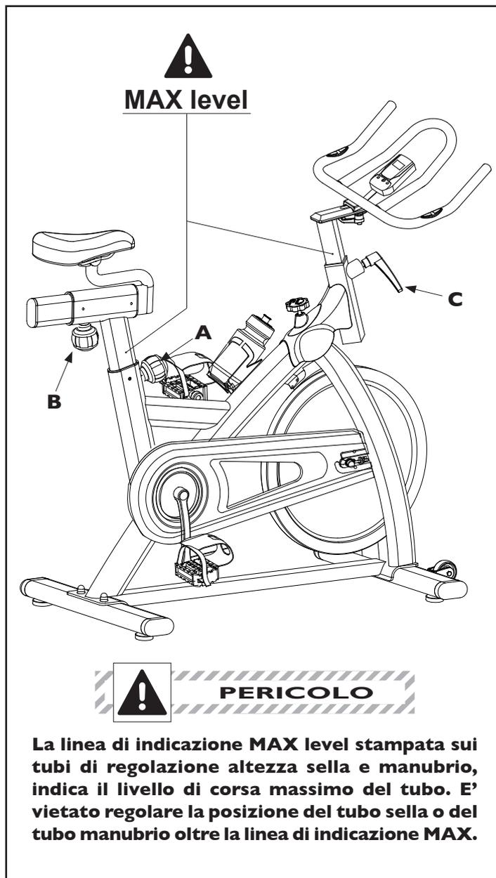
**La linea di indicazione MAX level stampata sui tubi di regolazione altezza sella e manubrio, indica il livello di corsa massimo del tubo. E' vietato regolare la posizione del tubo sella o del tubo manubrio oltre la linea di indicazione MAX.**
